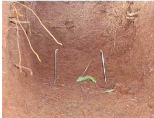
Figura 3. Instalación de clavos de erosión
